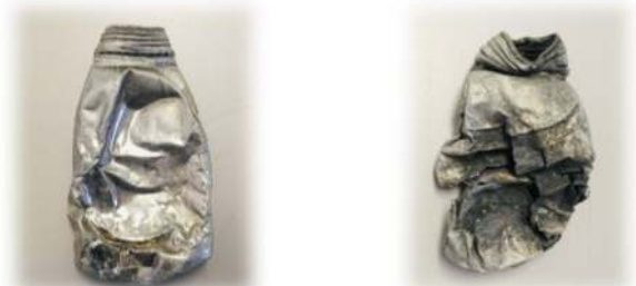
【熱で塗装を剥がした後のアルミ缶】 【異物が入っていて焦げたアルミ缶】
